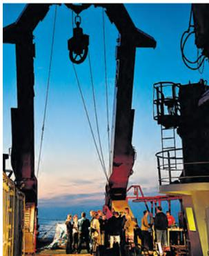
Der Flaschenzug dient der Handhabung der Geräte. Über die Rolle läuft das Tiefseekabel, an welches die geschleppten Geräte gehängt werden
