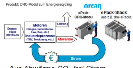
Aus Abwärme CO<sub>2</sub>-frei Strom durch Orcans ORC-Produkte
