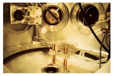
Reaktionskammer zum Nachweis von Spaltfragmenten aus induzierter Kernspaltung 238U wobei die Halbleiterdetektoren paarweise angeordnet sind. Die Uranprobe (Target) ist in der Mitte im oberen Bildteil erkennbar.
