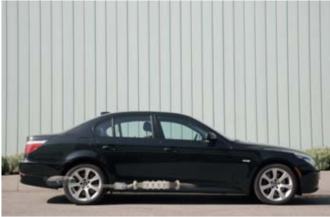
Am Stuttgarter DLR-Institut für Fahrzeugkonzepte wurde kürzlich ein thermoelektrischer Generator in den Abgasstrang eines BMW-Versuchsfahrzeugs integriert und erfolgreich getestet.
